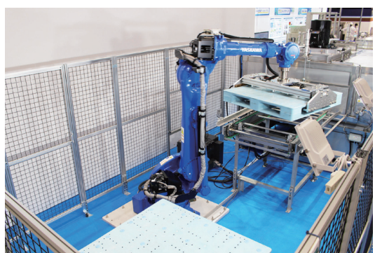
ロボットがパレットを1枚ずつ洗浄機に投入「パレット洗浄脱水ライン+ロボット」
